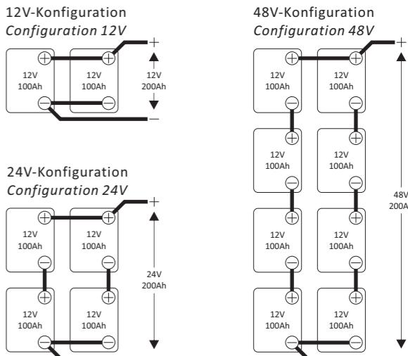
**Nach Abschluss der Installation das negative Batteriekabel immer zuletzt anschließen.
