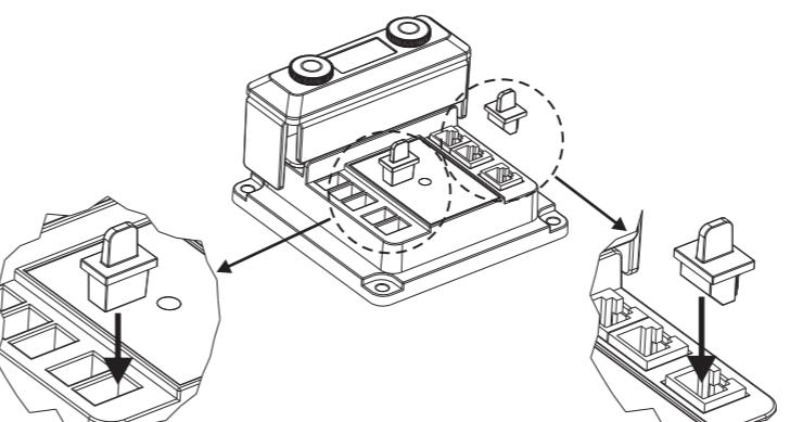
Siehe Abbildung oben, wie ungenutzte Anschlüsse des aktiven Shunt Moduls abzudecken sind. Eine Auswahl an Gummiaufladeiteilen ist im Lieferumfang enthalten. Reportez-vous à l'illustration ci-dessus sur la façon de couvrir les ports inutilisés du module shunt actif. Une sélection de caches en caoutchouc est incluse dans le paquet.
