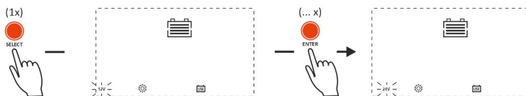
En este ejemplo se ha seleccionado un voltaje de sistema de 24 V Una vez pulsada la tecla SELECT, se muestra el primer parámetro de voltaje (voltaje de carga de ecualización), ver abajo:
