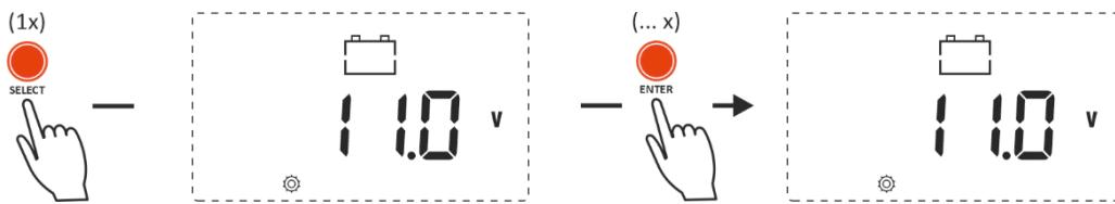
Deze parameter vertegenwoordigt de spanningswaarde waarbij het onderspanningsalarmrelais geactiveerd wordt. Deze kan worden gewijzigd door telkens kort op de ENTER toets te drukken om de waarde met 0,1 V te verhogen. Deze waarde moet altijd lager zijn dan de uitschakelwaarde van het onderspanningsalarm.
