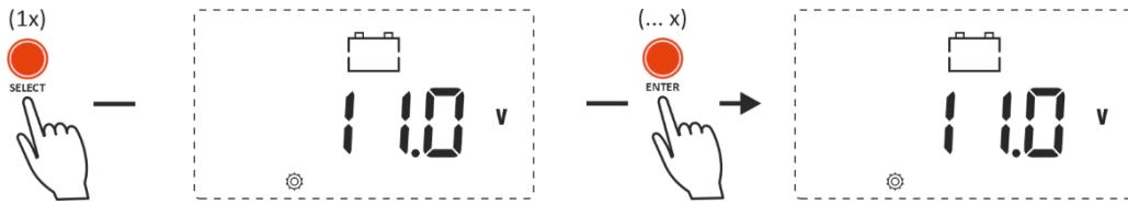
Este parámetro representa el valor de voltaje al que se activará el relé de alarma de baja tensión. Se puede editar pulsando cada vez la tecla ENTER para aumentar el valor en 0,1 V. Este valor siempre debe ser inferior que el voltaje de desactivación de la alarma de baja tensión.
