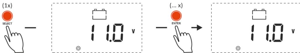
Ce paramètre représente la valeur de tension à laquelle le relais d'alarme de sous-tension sera activé. Appuyez sur le bouton ENTER pour modifier la valeur et l'augmenter par incrément de 0,1 V. Cette valeur doit toujours être inférieure à la valeur de désactivation de l'alarme de sous-tension.
