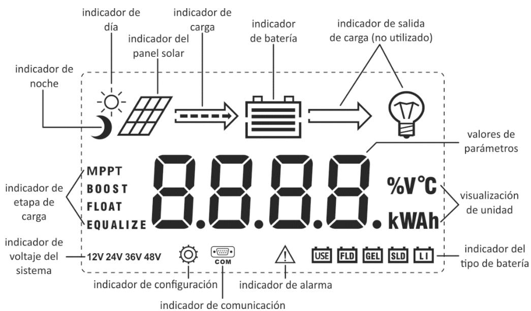
En el modo de funcionamiento normal, puede utilizar el botón SELECT para navegar cíclicamente por las siguientes pantallas:
