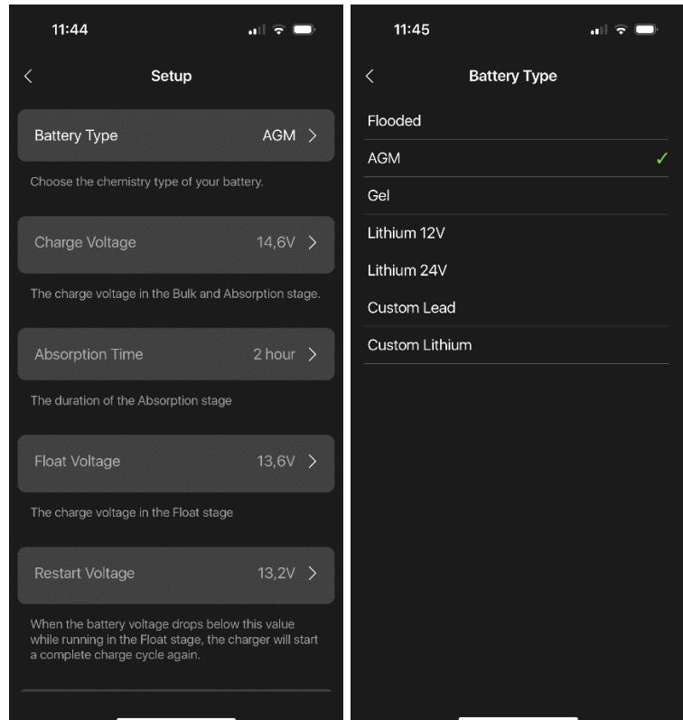
Sollte einer der standardmäßig auswählbaren Batterietypen Ihre Anforderungen nicht erfüllen, besteht die Möglichkeit, einen eigenen Batterietyp oder ein eigenes Ladeprogramm zu erstellen.
