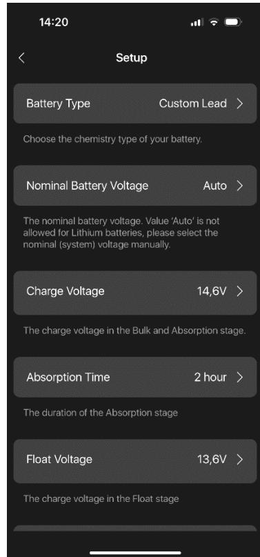
Wählen Sie dazu bitte im Setup-Bildschirm den Batterietyp „Custom Lead“ aus und verwenden Sie die folgenden Parametereinstellungen:
