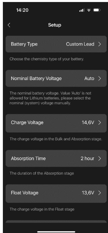
Pour cela, sélectionnez le type de batterie Custom Lead dans l'écran de configuration et utilisez les réglages de paramètres suivants :
