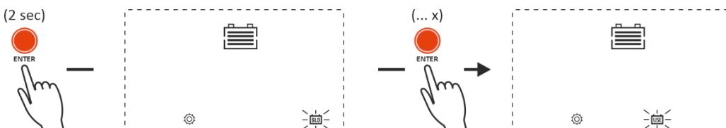
Appuyez plusieurs fois sur le bouton ENTER pour sélectionner le type de batterie USE, appuyez sur le bouton SELECT pour passer à la sélection de la tension du système et vérifiez que la tension du système correcte est sélectionnée comme illustré ci-dessous :
