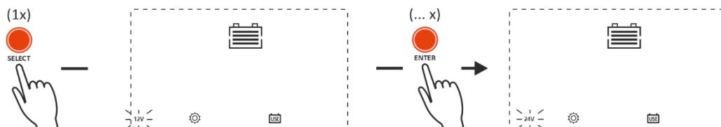
In diesem Beispiel wird eine 24V-Systemspannung gewählt. Wenn die Taste „SELECT“ gedrückt wird, wird der erste Spannungsparameter (Ladespannung ausgleichen) angezeigt, siehe unten:
