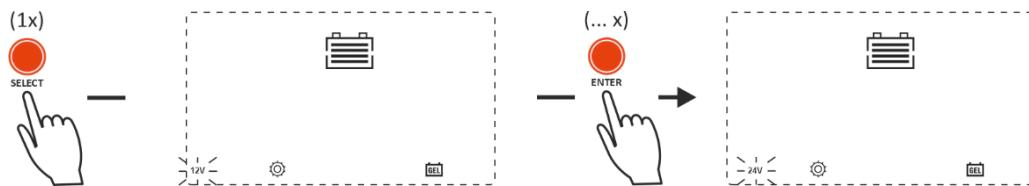
La selección de voltaje actual comienza a parpadear. Pulse la tecla ENTER varias veces hasta que el voltaje deseado del tipo de batería o del sistema parpadee. Puede elegir entre 12 V, 24 V, 36 V, 48 V y detección automática del voltaje (la pantalla muestra todos los voltajes disponibles parpadeando al
