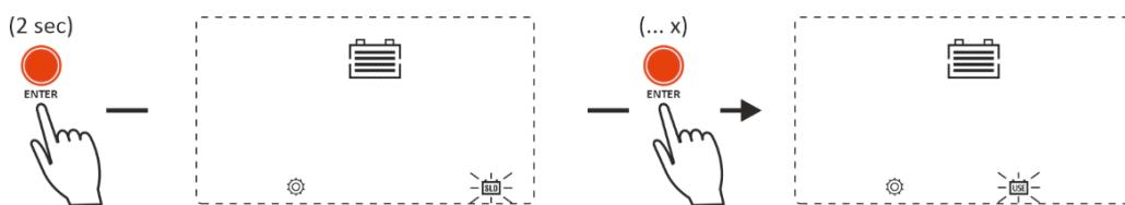
Nadat u een aantal keren op de ENTER toets hebt gedrukt om het USE accutype te selecteren, drukt u op de SELECT toets om naar de systeemspanningsselectie te gaan en controleert u of de juiste systeemspanning is geselecteerd, zoals in het onderstaande voorbeeld:
