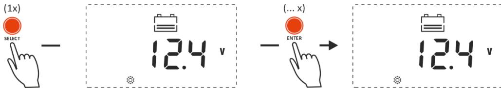
Dieser Parameter stellt den Spannungswert dar, bei dem das aktivierte Alarmrelais wieder deaktiviert und die Unterspannungsalarmmeldung gelöscht wird. Er kann durch kurzes Drücken der Taste „ENTER“ jedes Mal bearbeitet werden, um den Wert um 0,1 V zu erhöhen. Dieser Wert muss immer höher sein als die Auslösespannung des Unterspannungsalarmrelais.
