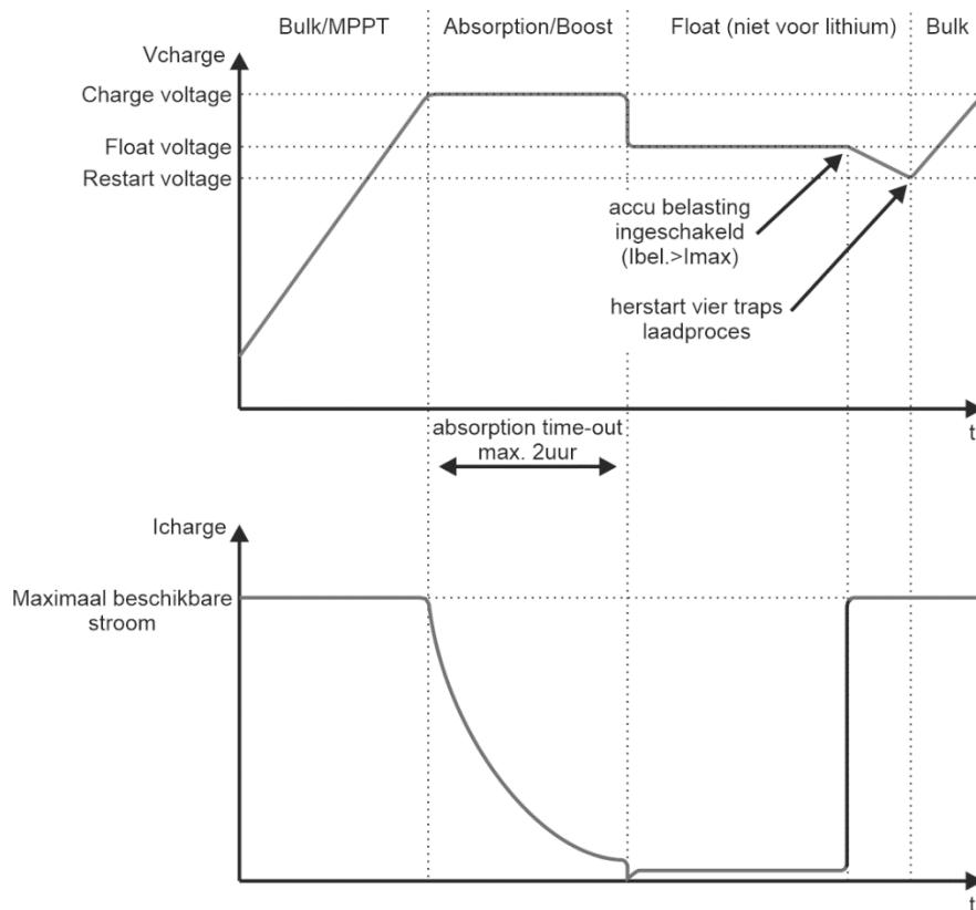
In de Bulk/MPPT-fase levert de acculader de volledige beschikbare uitgangsstroom en stuurt gewoonlijk ongeveer 80 % van de lading terug naar de accu, zodra de laadspanning is bereikt. Tijdens deze fase werkt de lader in MPPT-modus, waarbij maximaal PV-vermogen naar de accu wordt overgebracht.
