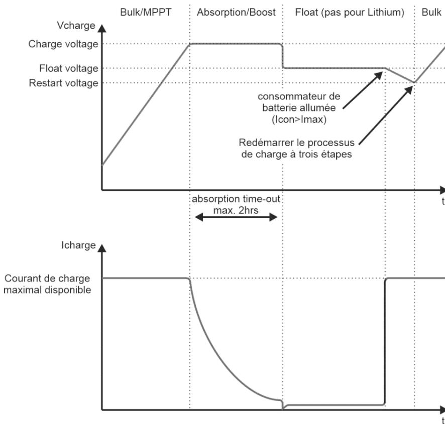
Dans la phase « Bulk/MPPT », le chargeur délivre un courant de sortie total et renvoie généralement environ 80 % de la charge dans la batterie, une fois la tension de charge atteinte. Au cours de cette phase, le chargeur fonctionne en mode MPPT, transférant la puissance PV maximale dans la batterie.
