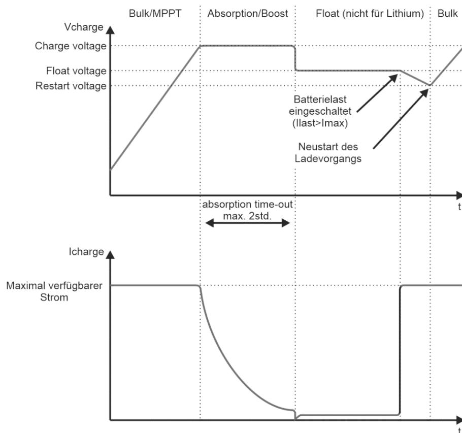
In der Bulk-/MPPT-Stufe liefert das Ladegerät den vollen verfügbaren Ausgangsstrom und gibt typischerweise etwa 80 % der Ladung zurück in die Batterie, sobald die Ladespannung erreicht ist. Während dieser Phase läuft das Ladegerät im MPPT-Modus und überträgt maximale PV-Leistung in die Batterie.
