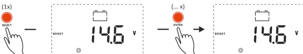
Diese Spannung kann durch kurzes Drücken der Taste „ENTER“ jedes Mal bearbeitet werden, um den Wert um 0,1 V zu erhöhen. Bei Erreichen von 17,0V springt der Spannungswert wieder auf 9,0V und kann wieder erhöht werden.
