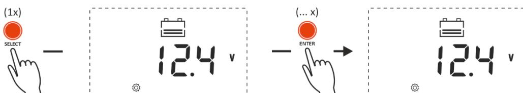
Este parámetro representa el valor de voltaje al que el relé de alarma activado se desactivará de nuevo, además de borrar el mensaje de alarma de baja tensión. Se puede editar pulsando cada vez la tecla ENTER para aumentar el valor en 0,1 V. Este valor siempre debe ser mayor que el voltaje de activación del relé de alarma de baja tensión.
