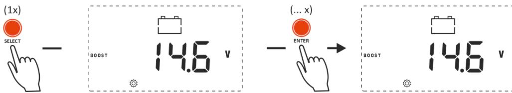
Deze spanning kan worden aangepast door telkens kort op de ENTER toets te drukken om de waarde met 0,1 V te verhogen. Wanneer 17,0 V is bereikt, springt de spanningswaarde terug naar 9,0V en kan deze weer worden verhoogd.
