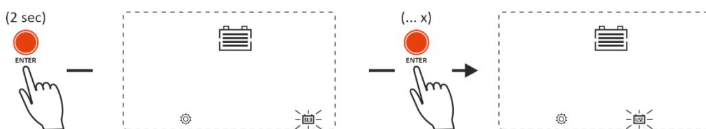
Después de presionar la tecla ENTER varias veces para seleccionar el tipo de batería USE, presione la tecla SELECT para pasar a la selección de voltaje del sistema y asegúrese de que se seleccione el voltaje correcto del sistema como se muestra en el siguiente ejemplo:
