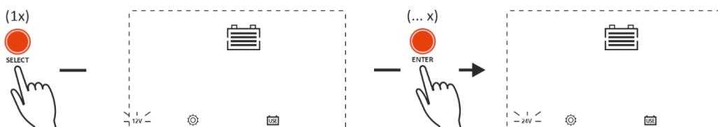
Dans cet exemple, une tension système de 24 V est sélectionnée. Lorsque vous appuyez sur le bouton SELECT, le premier paramètre de tension (Tension de charge d'égalisation) s'affiche, comme illustré ci-dessous :
