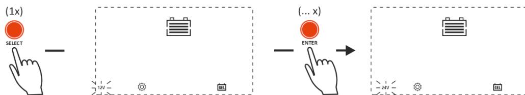
Het huidige geselecteerde voltage begint te knipperen. Druk een aantal keren op de ENTER toets totdat de gewenste accu- of systeemspanning knippert. U kunt kiezen tussen 12 V, 24 V, 36 V, 48 V en Automatische spanningsdetectie (op het display knipperen alle beschikbare spanningen tegelijkertijd). Let op: automatische detectie is niet beschikbaar voor accu's op Lithium-basis.
