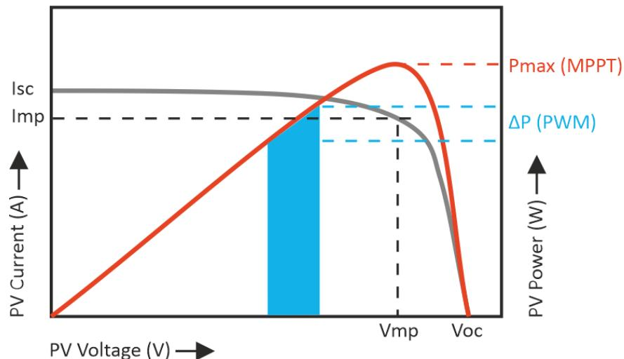
La zone bleue dans le graphique ci-dessus ( $\Delta P$ ) représente la zone de fonctionnement typique d'un contrôleur de charge solaire de type PWM traditionnel. Comme vous pouvez le voir,  $P_{max}$  (MPPT) est supérieur à  $\Delta P$  (PWM).
