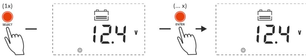
Deze parameter geeft de spanningswaarde aan waarbij het geactiveerde alarmrelais weer wordt gedeactiveerd, naast het wissen van het onderspanningsalarmbericht. Deze kan worden gewijzigd door telkens kort op de ENTER toets te drukken om de waarde met 0,1 V te verhogen. Deze waarde moet altijd hoger zijn dan de triggerspanning van het onderspanningsalarmrelais.
