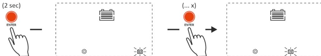
Nachdem die Taste „ENTER“ mehrmals gedrückt wurde, um den USE Batterietyp auszuwählen, drücken Sie die Taste „SELECT“, um zur Auswahl der Systemspannung zu springen, und stellen Sie sicher, dass die richtige Systemspannung ausgewählt ist, wie im folgenden Beispiel:
