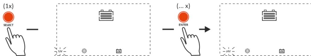
In dit voorbeeld is een systeemspanning van 24 V geselecteerd. Wanneer u op de SELECT toets drukt, wordt de eerste spanningsparameter (Equalize charge voltage) weergegeven, zie hieronder:
