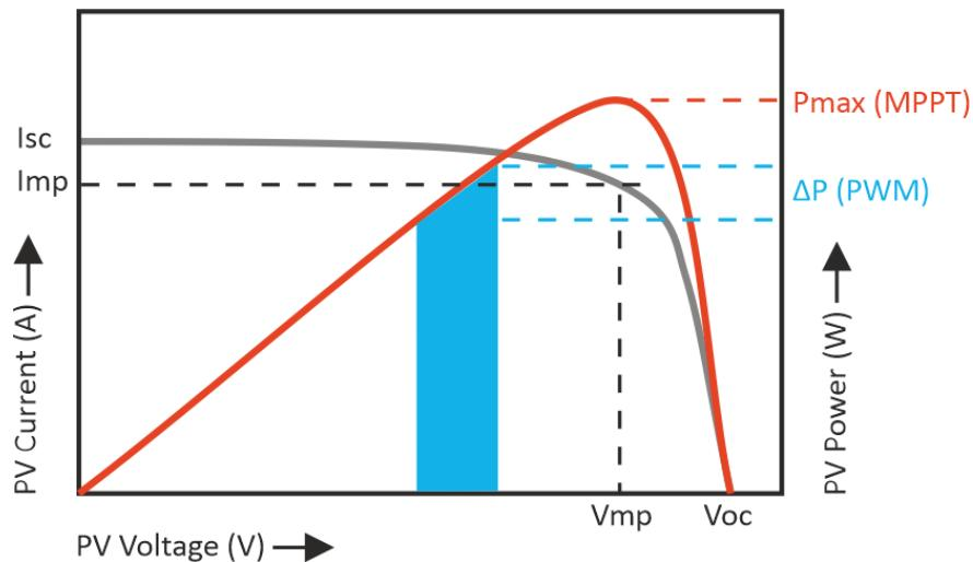
El área azul en el gráfico anterior ( $\Delta P$ ) representa el área típica de operación de un controlador de carga solar tipo PWM tradicional. Como puede ver, Pmax (MPPT) es más alto que  $\Delta P$  (PWM).
