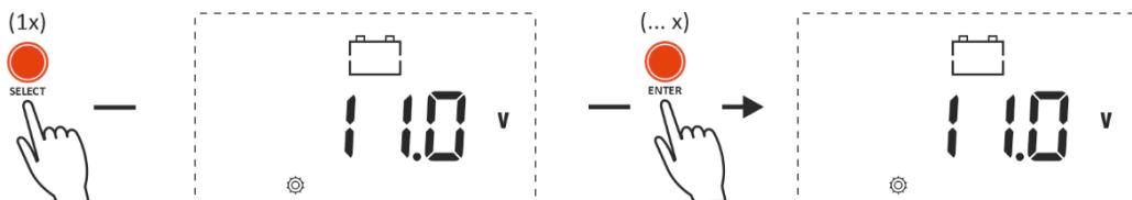
Dieser Parameter stellt den Spannungswert dar, bei dem das Unterspannungsalarmrelais aktiviert wird. Er kann durch kurzes Drücken der Taste „ENTER“ jedes Mal bearbeitet werden, um den Wert um 0,1 V zu erhöhen. Dieser Wert muss immer niedriger sein als der Unterspannungsalarm-Aus-Wert.
