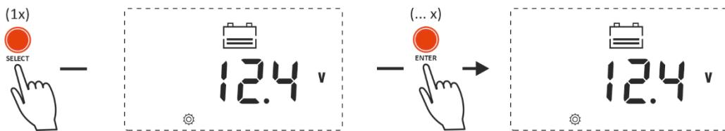
Ce paramètre représente la valeur de tension à laquelle le relais d'alarme se désactivera après une activation. Le message d'alarme de sous-tension disparaîtra également. Appuyez sur le bouton ENTER pour modifier la valeur et l'augmenter par incrément de 0,1 V. Cette valeur doit toujours être supérieure à la tension de déclenchement du relais d'alarme de sous-tension.
