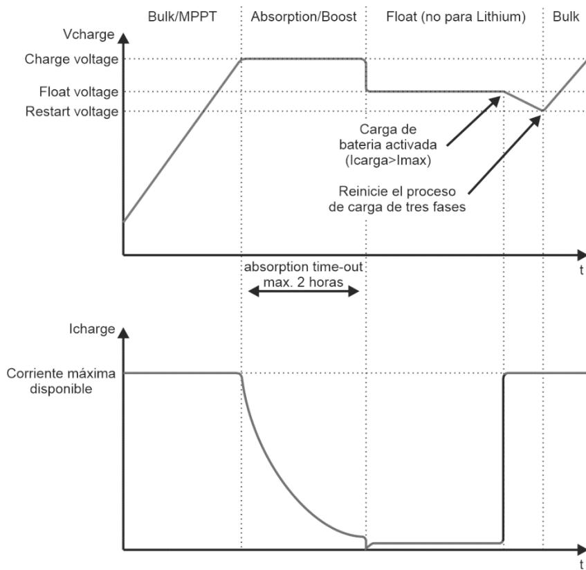
En la etapa Bulk/MPPT, el cargador proporciona la corriente de salida completa y normalmente devuelve el 80 % de la carga a la batería cuando se alcanza el voltaje de carga. Durante esta etapa, el cargador funciona en modo MPPT, transfiriendo la máxima energía fotovoltaica a la batería.
